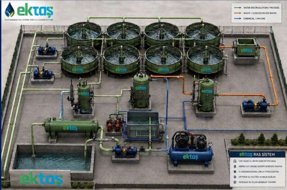
RAS geri dönüşüm sistemi — tanklar, biyofiltre, degazör ve UV / recirculating aquaculture system: tanks, biofilter, degasser and UV
