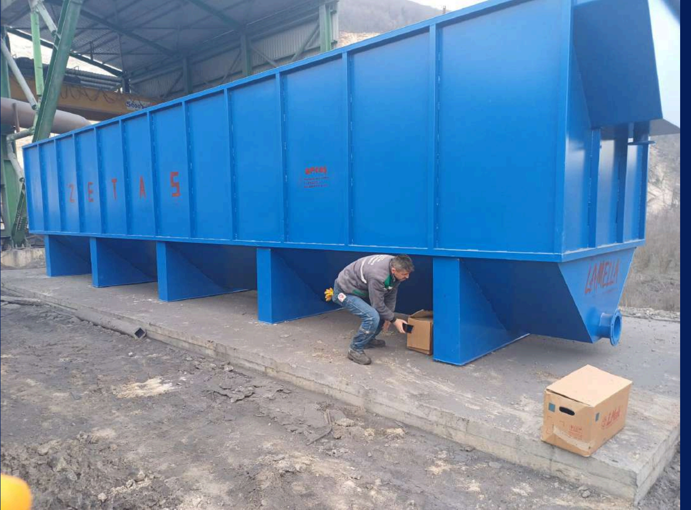
Lamella durultucu — karbon çelik gövde, konik çamur hazneleri, imalat sahası / lamella clarifier, carbon steel body with conical sludge hoppers, at works
