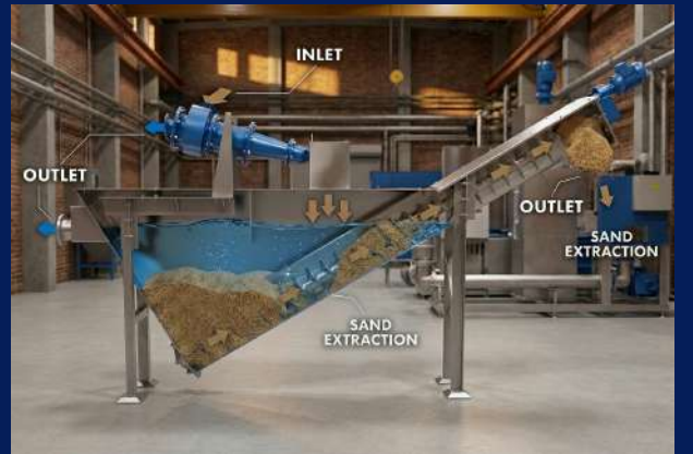
Helezonlu kum sınıflandırıcı — kesit / screw grit classifier, section
